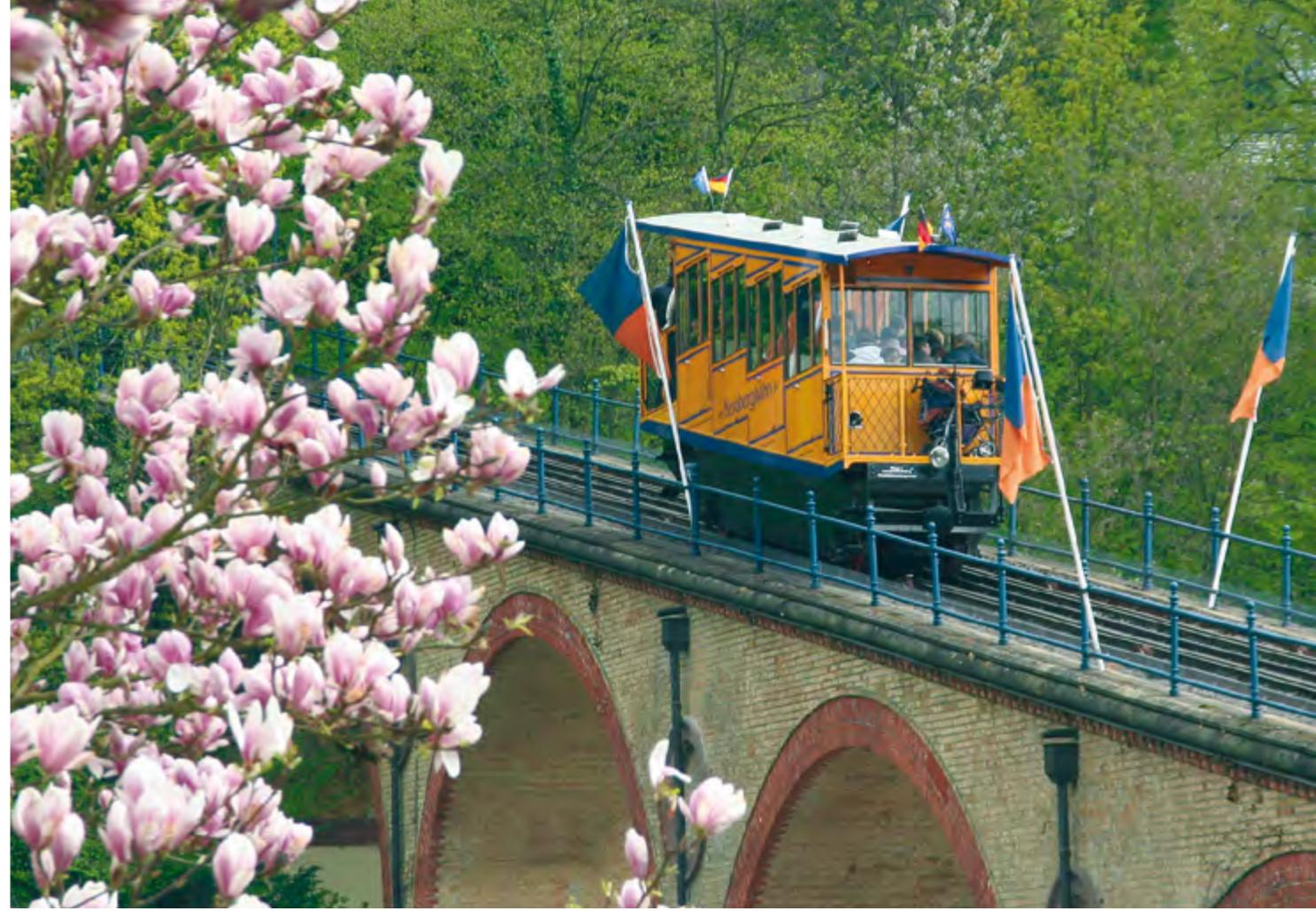
Die **Nerobergbahn** ist die älteste Drahtseil-Zahnstangenbahn Deutschlands, die mit Wasserballast betrieben wird und auf den Wiesbadener Hausberg hinaufführt. 1888 erbaut, ist sie ein Kulturdenkmal. Die Fahrstrecke ist 438 m lang und hat eine mittlere Steigung von ca. 19 %. Bei einer Sonderfahrt im „Hochzeitswagen“ kann man auf Wunsch die Ehe schließen.
